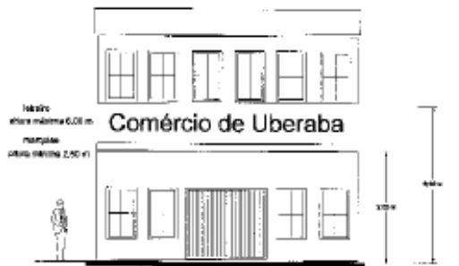
ART. 209208 - VEÍCULO DE DIVULGAÇÃO EM MARQUISE VISTA FRONTAL Letreiro não pode ultrapassar limite de edificação
