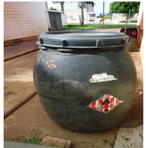
Imagem 08: Resíduos gerados no empreendimento de lama da caixa (SAO) devidamente acondicionados, aguardando destinação para empresa coletora responsável. Autor: Esfera Ambiental 2013.
