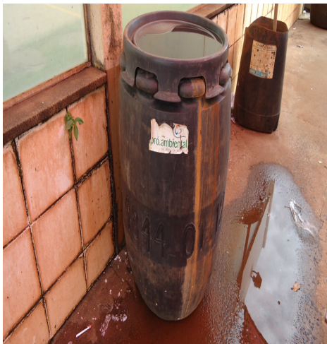
Imagem 08: Resíduos gerados no empreendimento de lama da caixa (SAO) devidamente acondicionados, aguardando destinação para empresa coletora responsável. Autor: Esfera Ambiental 2013.
