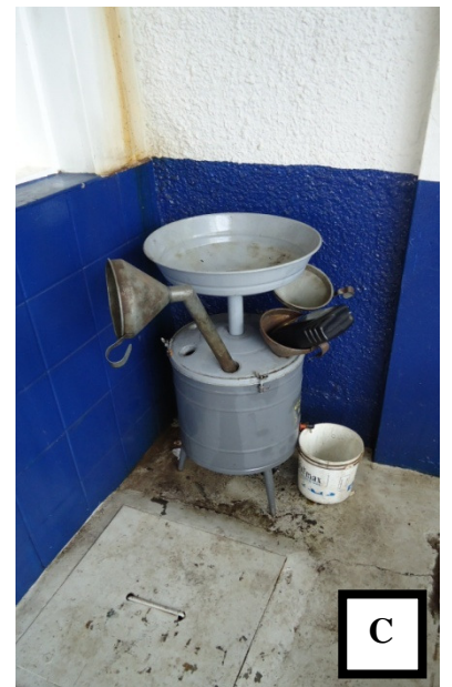
Imagem 04: Em (A) área de troca de óleo do empreendimento constituída em piso em concreto usinado impermeável, em (B) depósito para armazenamento dos óleos lubrificantes e em (C) embalagens de óleo usado em bacia de contenção para retirada de excesso de óleo. Autor: Esfere Ambiental 2013 .
